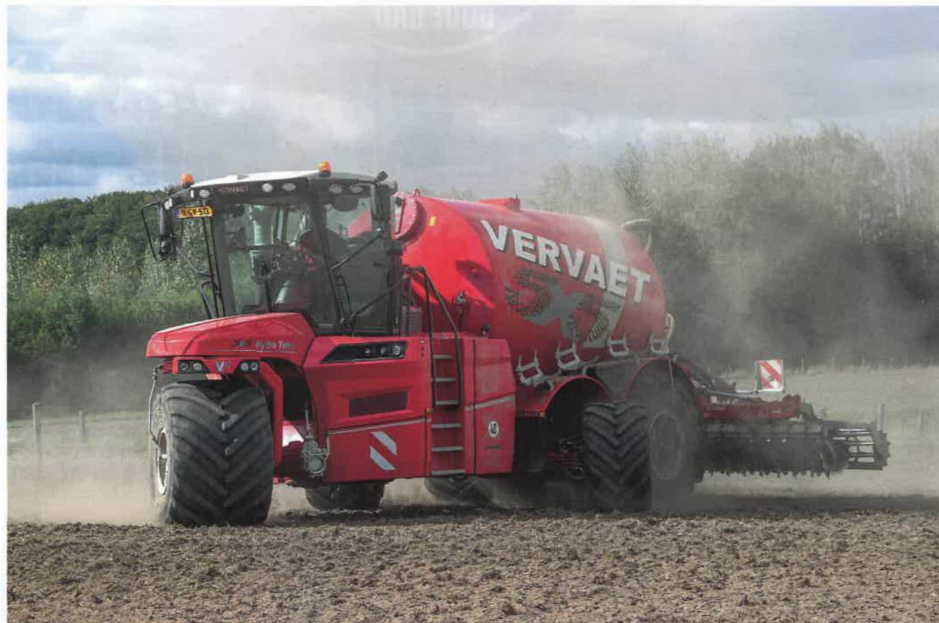
Vervaet gyllenedfælder. Den model, der er mest efterspurgt i Danmark, er denne Vervaet HydroTrike XL med 20 kubikmeter tank, hydraulisk udskud på midteraksel og fuldt styreudslag på midteraksel. Den har fem hjul i fem spor og med træk på alle hjul. Jorden overkøres kun en gang, og marktrykket er, ifølge Steen Lerche Hansen fra Valtec, lavt. Foto: Valtec.
